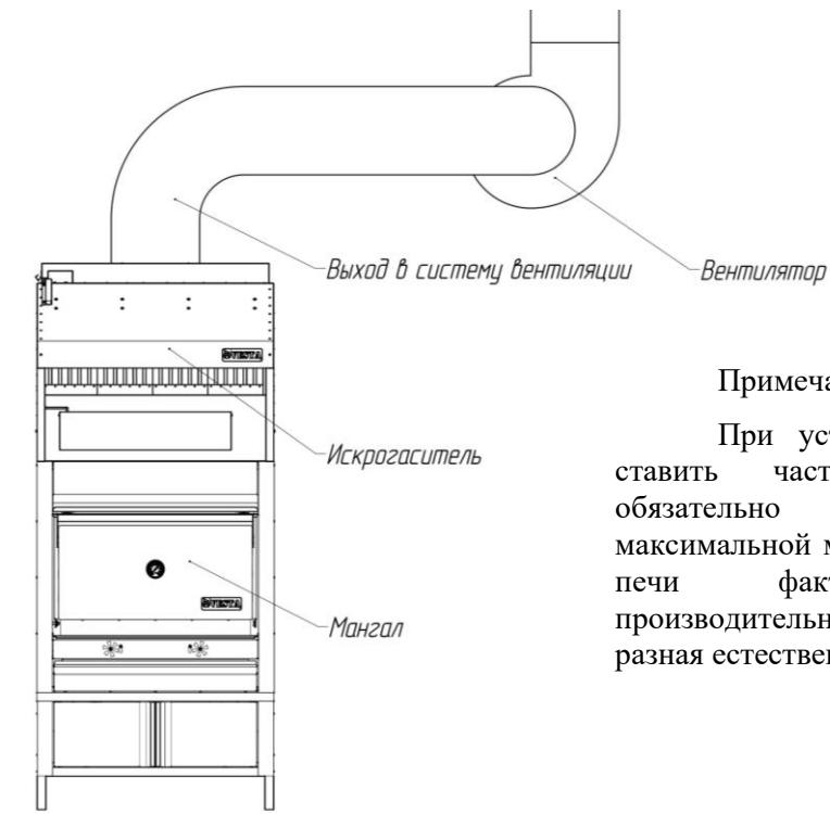
Подключение печи-мангала к системе вытяжной вентиляции можно производить только через фильтр-искрогаситель с водяной завесой. Требования к воздуховодам – в соответствии с СП 60.13330.2020 раздел 7.
